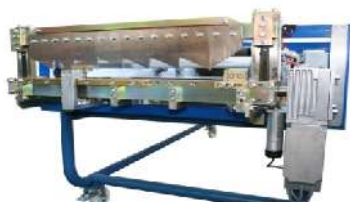
Detailopname guillotineschaar (K1-QB), electromotor (K1-EUQB). Afb. zonder cover
