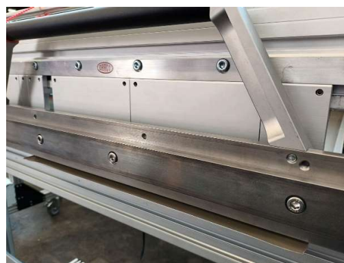
Schritt 6 Blech mit der Oberwange klemmen.
