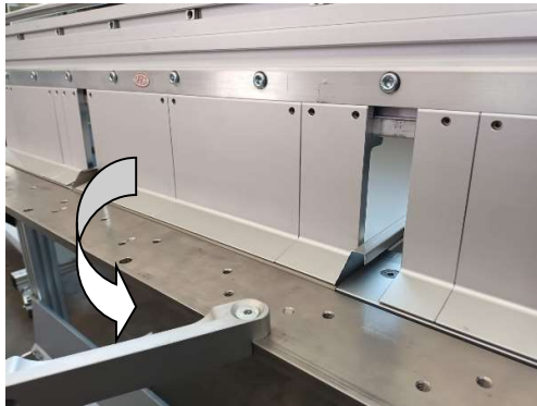
Schritt 7 Unterwange bis zum Anschlag nach unten klappen.
