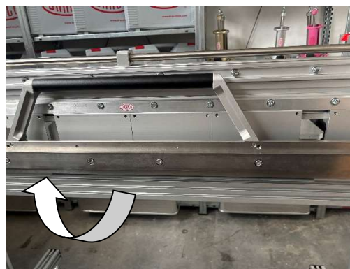
Schritt 4 Oberwange öffnen Unterwange ganz nach oben schwenken
