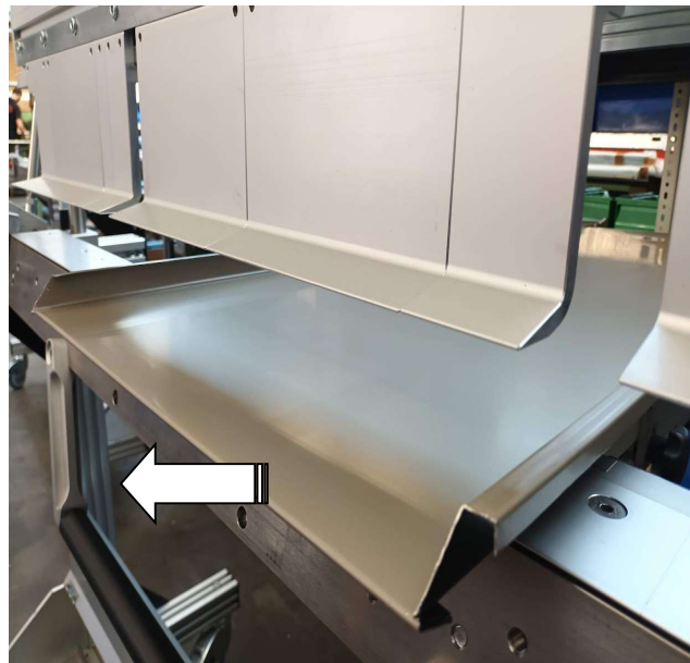
Schritt 9 Schare nach vorne aus der Abkantbank herausziehen.
