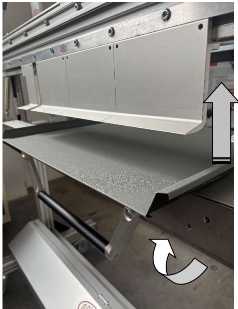
Schritt 8 Oberwange ganz öffnen. Unterwange leicht nach vorne bewegen bis die Schare locker herausgezogen werden kann.
