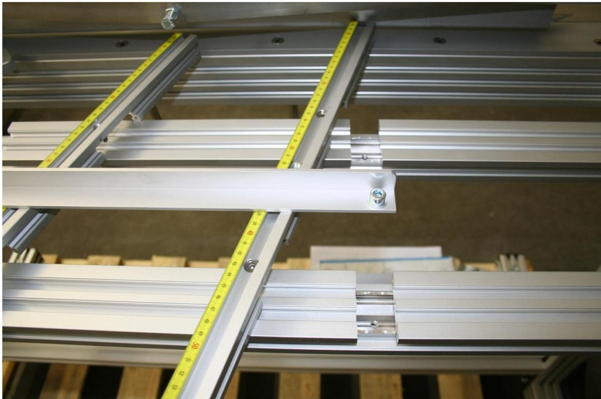
Bild 2 Führungen und Anschlagwinkel zur Montage vorbereitet.
