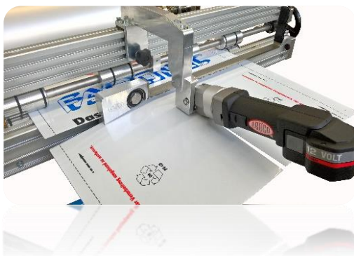
Optionale Längsschneideeinrichtung K1-LSE-2 zum Spalten von Coils (ohne Schere)
