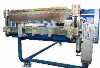
Détail de la coupe (K1-QB) avec moteur électrique (K1-EUQB). Image sans capot de protection.
