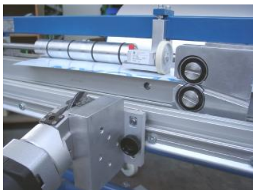
Optionale Längsschneideeinrichtung K1-LSE zum Spalten von Coils (Abb. mit optionaler Schere und K1-AQ)
